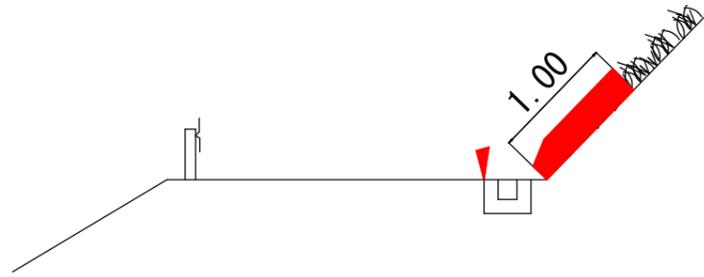
Ⓑ ブロック積み（コンクリート擁壁）石積みの天端より0.50m
